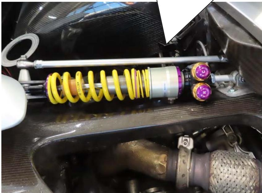
**Der Anschluss des Ringzylinders muss in Richtung Fahrzeugaußenseite zeigen.**
