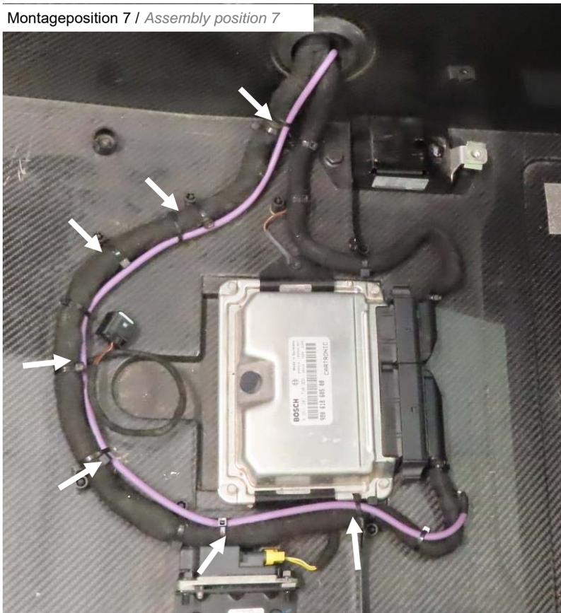
CAN Leitung mit Kabelbinder am Kabelbaum befestigen.
