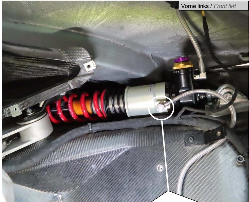
Der Anschluss des Ringzylinders muss zur Fahrzeugvorderseite zeigen.
