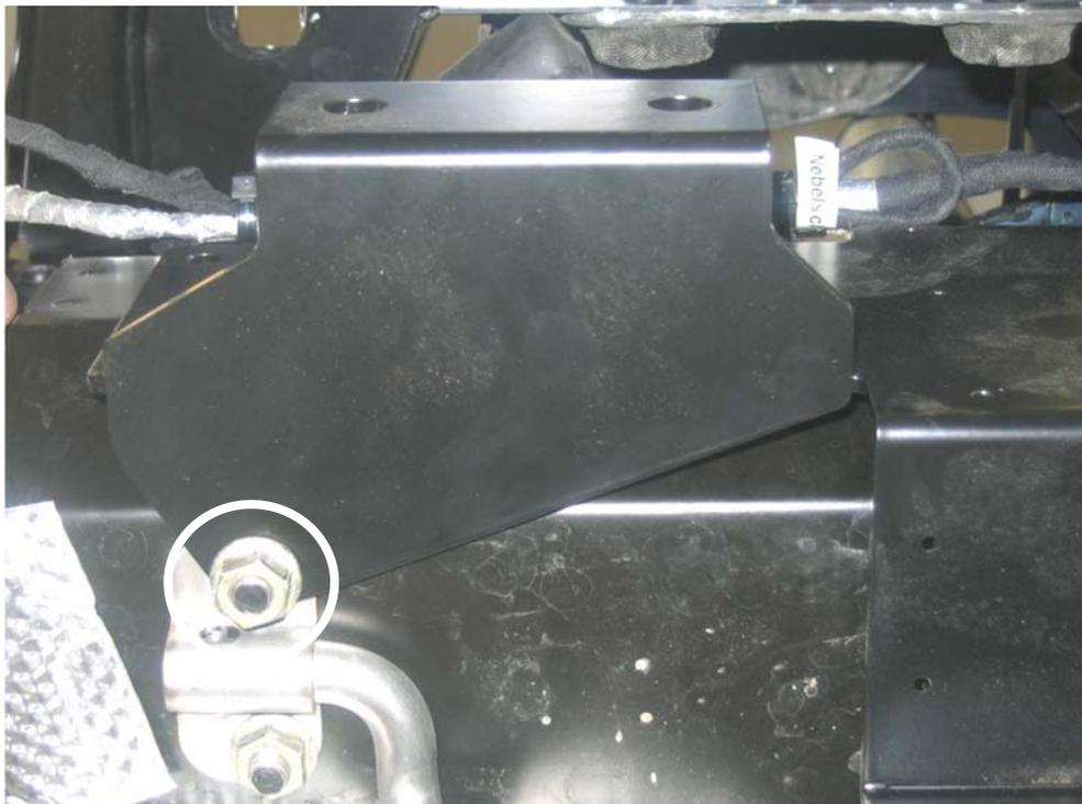
Bohrschablone mit der Schraube der Abgasanlage am Fahrzeug montieren.
