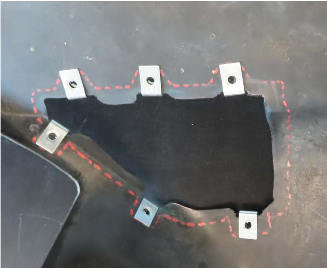
Abdeckung mit 6 Schrauben montieren.
