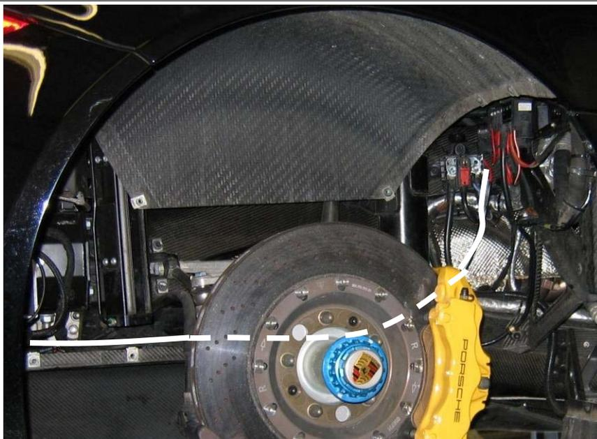
Leitung entlang der Hydraulikleitung zum Plus - Masseverteiler verlegen und auf entsprechende Länge kürzen.
