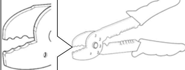
Masseleitung (blau) 8 mm abisolieren und mitgelieferten Kabelschuh 8mm mit geeignetem Werkzeug an der Masseleitung (blau) montieren.
