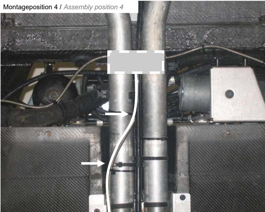
Hydraulikleitung (4300 mm) mit dem Verteiler verbinden. Anzugsdrehmoment 15Nm.
