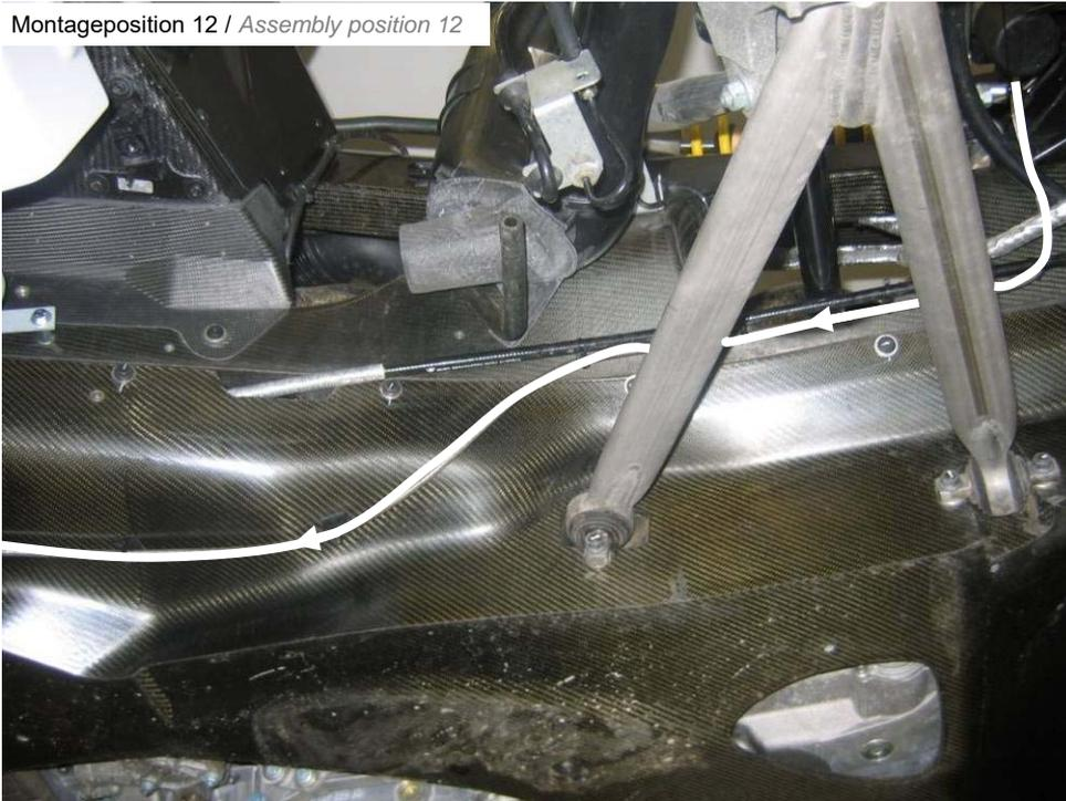
Hydraulikleitung (4500 mm) mit Klebepads am Fahrzeug und an der VA Hydraulikleitung befestigen. Kabelbinder erst nach vollständiger Leitungsverlegung festziehen. Sollte es vorkommen, dass die Hydraulikleitung über einer Scharfen Kante verläuft, ist die Hydraulikleitung mit einem Spiralband zu schützen.
