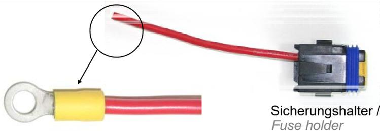
Plusleitung (rot) 8 mm abisolieren und mitgelieferten Kabelschuh 6mm mit geeignetem Werkzeug an der Plusleitung (rot) montieren.
