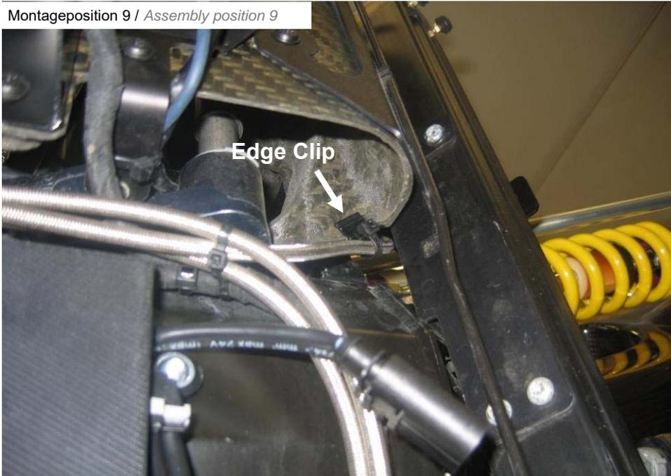
Hydraulikleitung (800 mm) mit Kabelbinder an am Fahrzeug und an den anderen Hydraulikleitungen befestigen. Kabelbinder erst nach vollständiger Leitungsverlegung festziehen. Sollte es vorkommen, dass die Hydraulikleitung über einer Scharfen Kante verläuft, ist die Hydraulikleitung mit einem Spiralband zu schützen.
