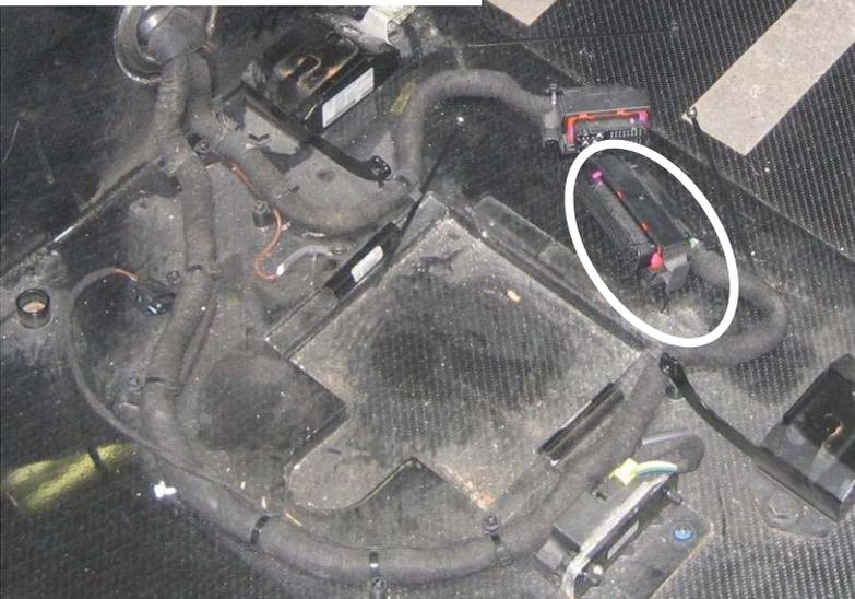
Gehäuse des markierten Steckers entfernen. Steckernummer: 150 906385L
