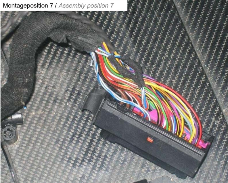
HLS CAN Leitung an die original CAN Leitung anlöten und anschließend Lötstelle isolieren.
