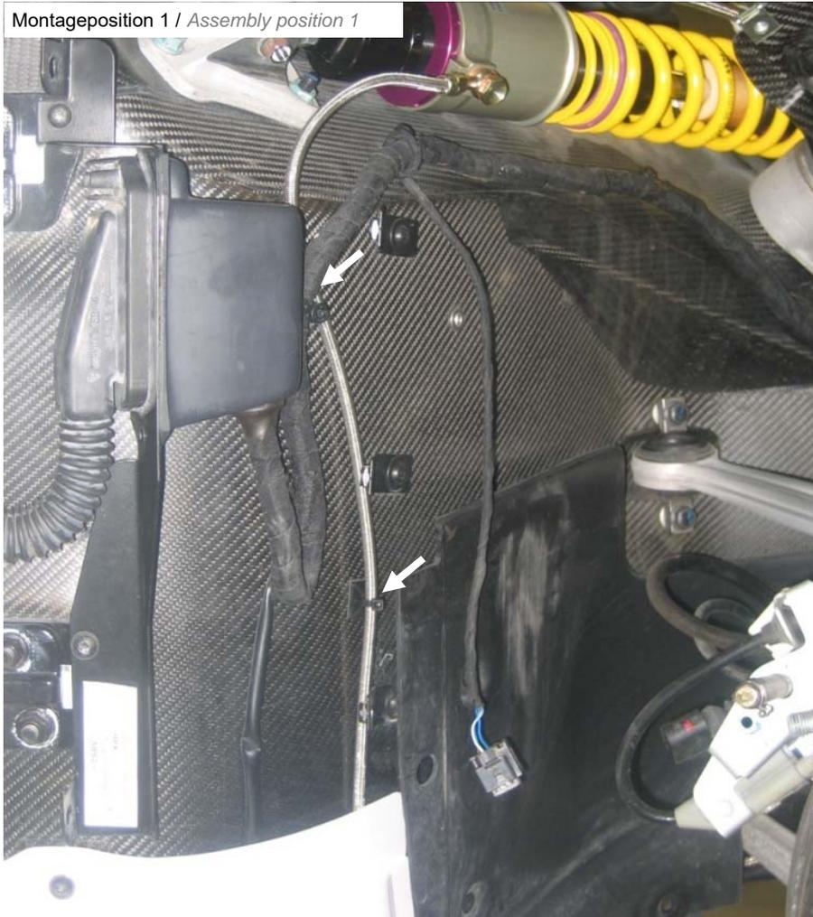
Hydraulikleitung (1800 mm) am HLS Ringzylinder mit der mitgelieferten Hohlschraube und 2 Dichtscheiben montieren.
