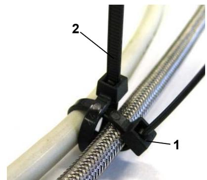
Hydraulikleitung mit Kabelbinder und Klebepads am Fahrzeug befestigen.
