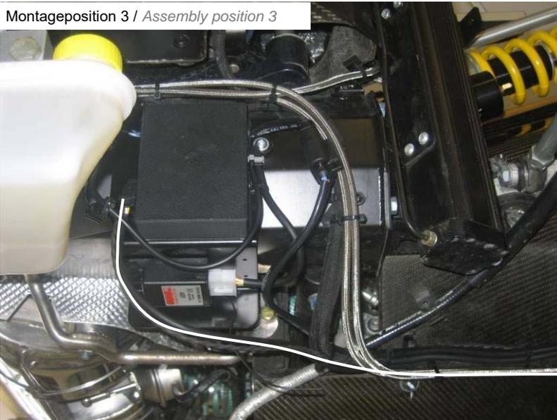
Mitgelieferte CAN Leitung und Tasterleitung in das HLS Steuergerät einstecken und Stecker verriegeln. CAN Leitung entlang der Hydraulikleitung zur Fahrzeugmitte verlegen
