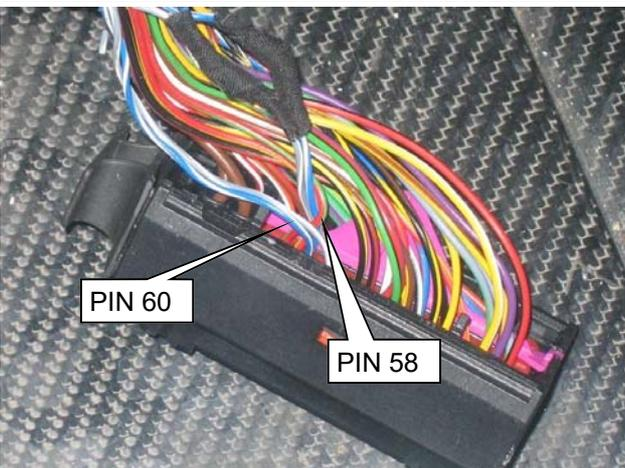
Original CAN Leitung PIN 60 und PIN 58 ca. 20 mm abisolieren. **Leitung nicht durchtrennen.**
