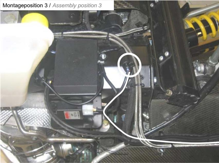
Spannungsversorgungsleitung mit dem Hydraulikaggregat verbinden.
