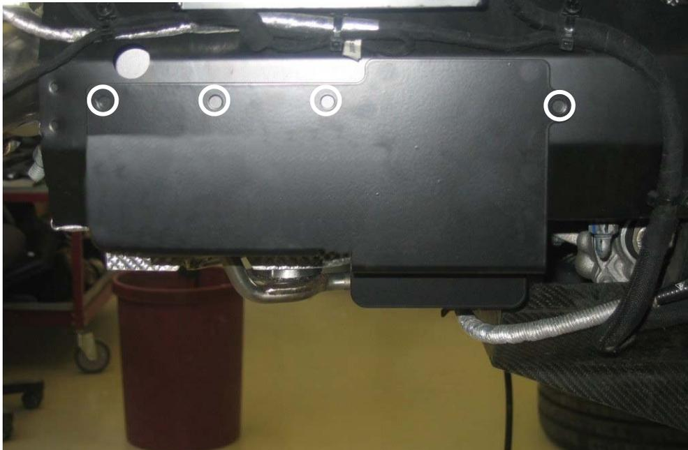
Bohrungen der Halterung markieren und mittig bohren Ø 9mm.
