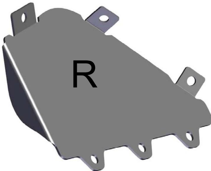
Innenradhausverkleidung demontieren und die Abdeckung platzieren. Anschließend die 6 Bohrungen sowie den Umriss der Abdeckung auf die Verkleidung übertragen.
