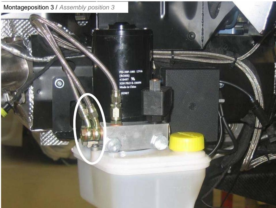
Hydraulikleitungen am Hydraulikaggregat mit der mitgelieferten doppelten Hohl-schraube und 3 Dichtscheiben montieren. Anzugsdrehmoment 15Nm.
