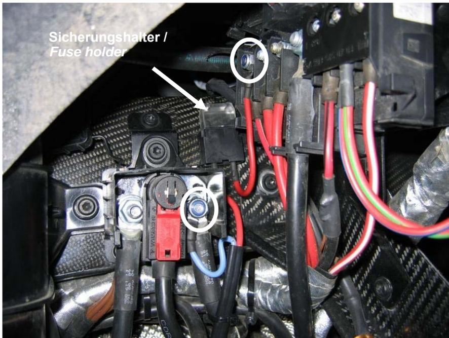
Masseleitung und Plusleitung an der Verteilerleiste montieren.
