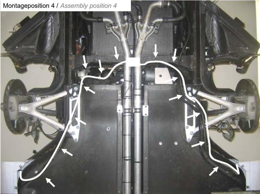
Hydraulikleitung verlegen und mit dem Verteiler verbinden. Der Verteiler wird zwischen Karosserie und Kühlleitungen befestigt.
