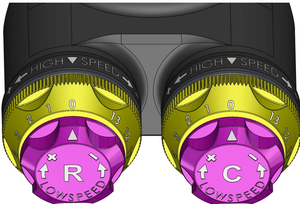
R → Rebound-Ventil – Ausfederbewegung (Zugstufe)
