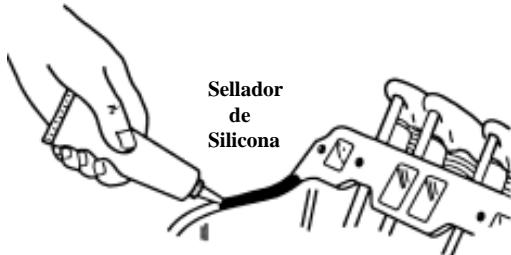
**FORME LOS SELLOS FINALES DEL MULTIPLE DE ADMISION** aplicando una perla 1/8 continua 1/8" de sellador de silicona sobre los extremos delanteros y traseros del bloque de cilindros, lleno de la culata de un cilindro hacia la culata del otro cilindro.
