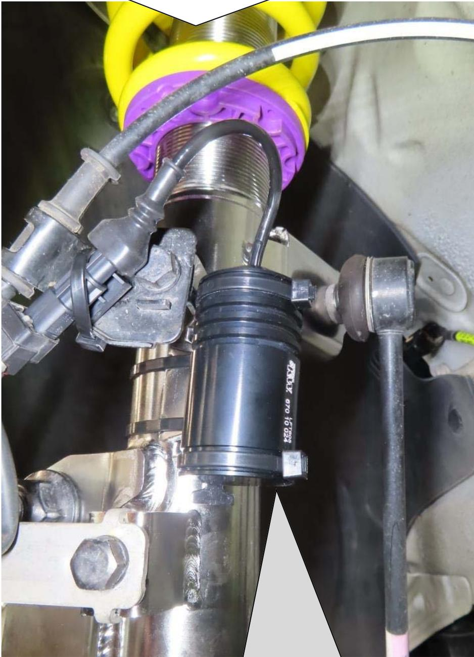
Stilllegung muss in Richtung Fahrzeugheckseite zeigen.
