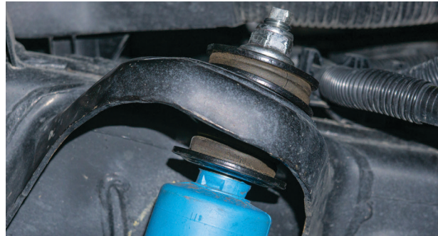
Fig. 28: Remove stem top nut.
