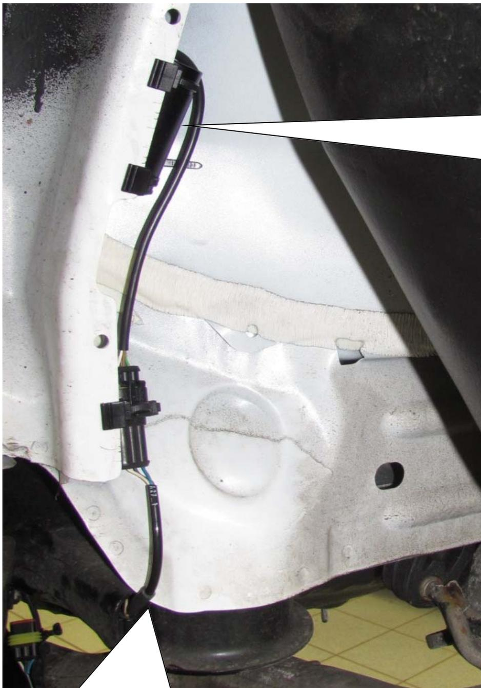
Stilllegung und Adapterkabelbaum mit den mitgelieferten Edge Clips an der Karosseriekante befestigen. Adapterkabel in die Stilllegung einstecken. Auf die korrekte Verriegelung des Steckers achten!
