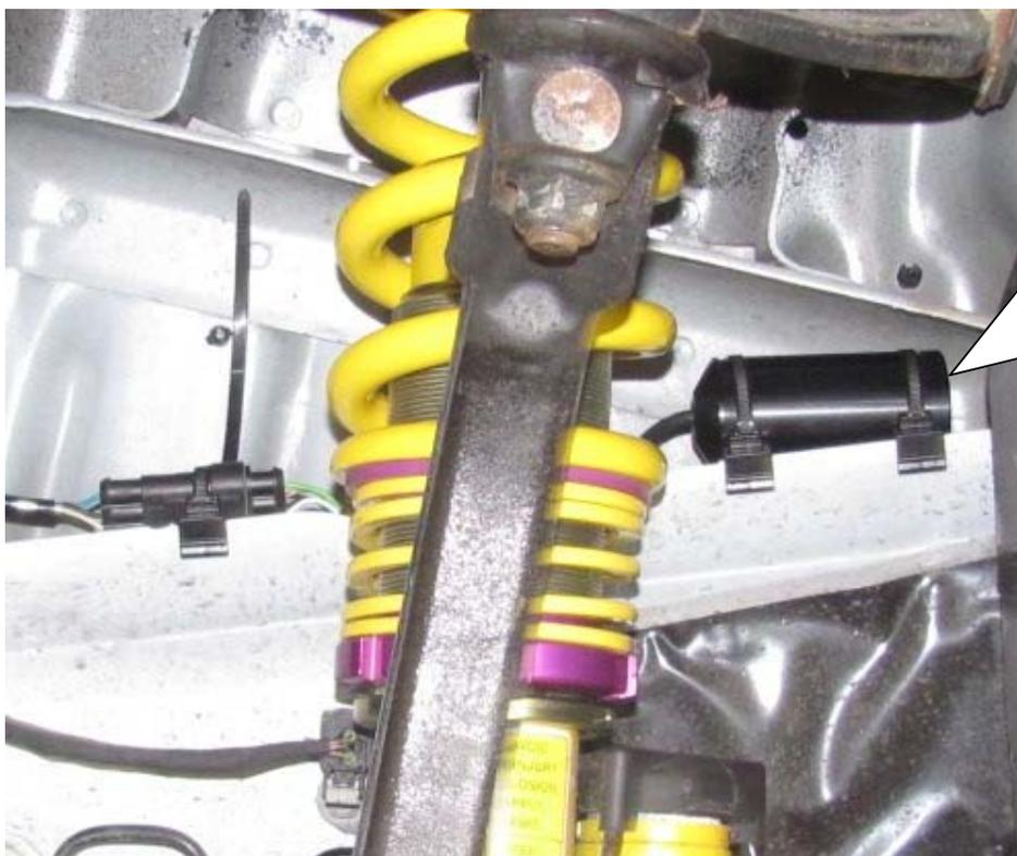
Stilllegung und Adapterkabelbaum mit den mitgelieferten Edge Clips an der Karosseriekante befestigen. Adapterkabel in die Stilllegung einstecken. Auf die korrekte Verriegelung des Steckers achten!
