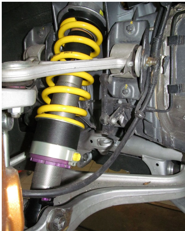
Gewindefederbein mit HLS-Ringzylinder (abgesenkt) Adjustable strut with HLS ring-cylinder (lower position)
