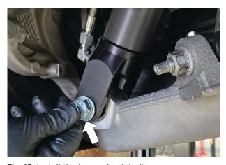
Fig. 15: Install the lower shock bolt.
