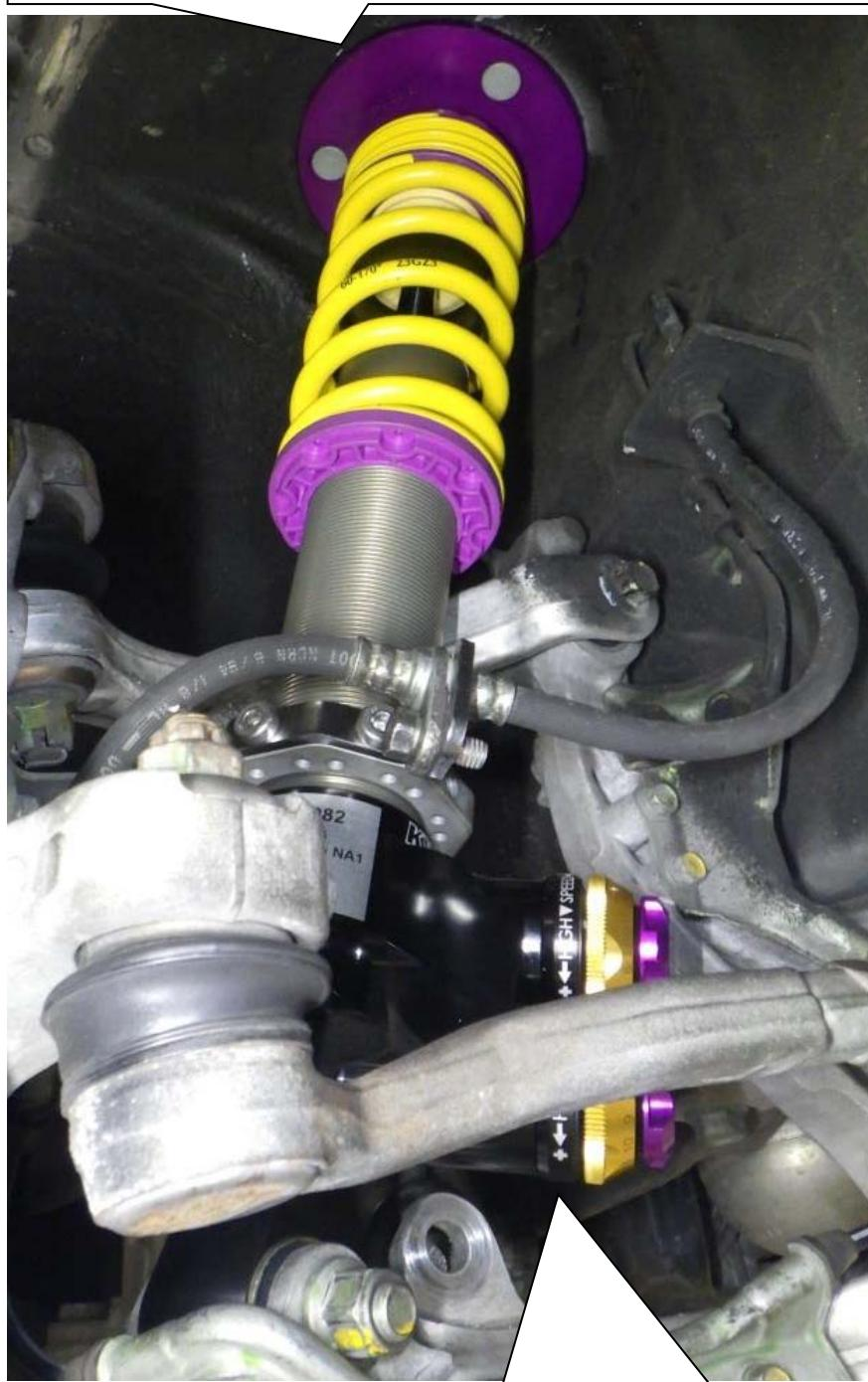
Der Dämpfer muss so montiert werden, dass die Ventiltechnik in Richtung Innenseite zeigt.
