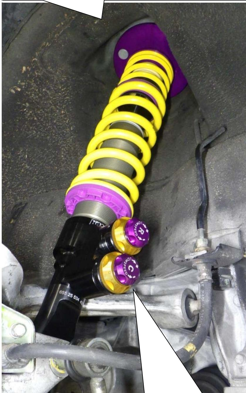
Der Dämpfer muss so montiert werden, dass die Ventiltechnik in Richtung Fahrzeughockseite zeigt.
