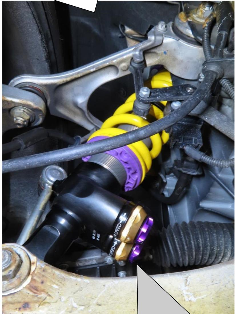
Der Dämpfer muss so montiert werden, dass die Einstellräder in Richtung Fahrzeuginnenseite zeigen.
