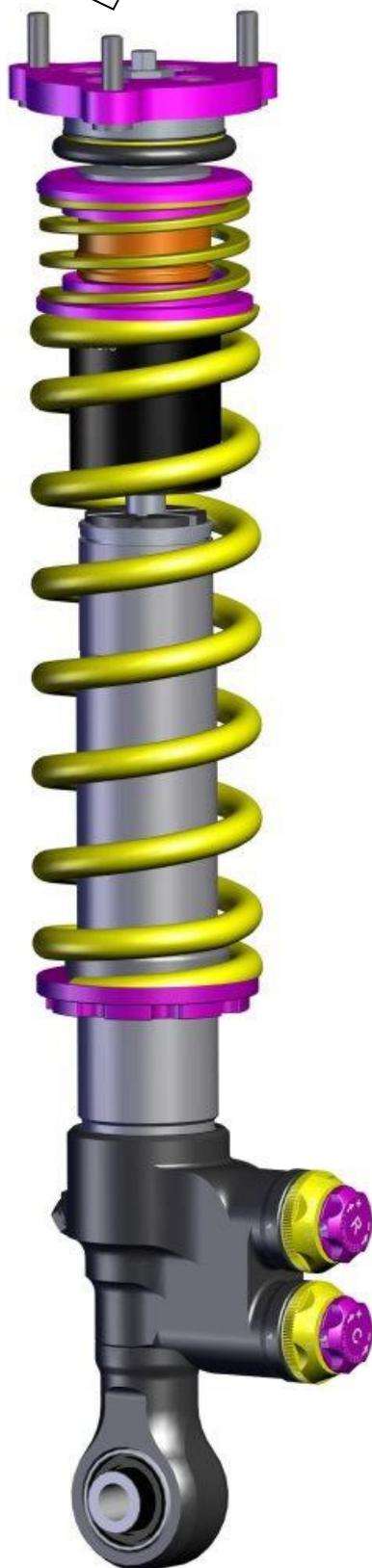
Das Anzugsdrehmoment der Stützlagerebefestigung beträgt 25 Nm. Die Montagehinweise zum Einbau des Federbeines in das Fahrzeug, sowie die Anzugsdrehmomente der unteren Federbeinbefestigung, entnehmen Sie bitte den Unterlagen des Fahrzeugherstellers.
