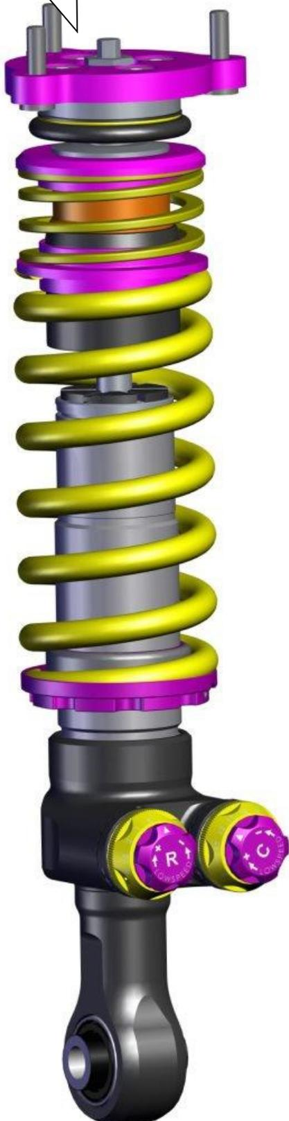
Das Anzugsdrehmoment der Stützlagerebefestigung beträgt 25 Nm. Die Montagehinweise zum Einbau des Federbeines in das Fahrzeug, sowie die Anzugsdrehmomente der unteren Federbeinbefestigung, entnehmen Sie bitte den Unterlagen des Fahrzeugherstellers.
