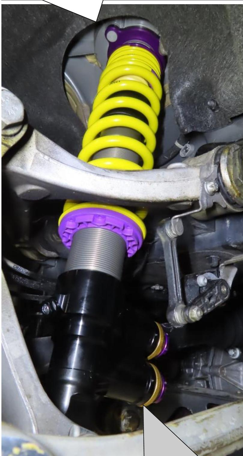
Der Dämpfer muss so montiert werden, dass die Einstellräder in Richtung Fahrzeuginnenseite zeigen.
