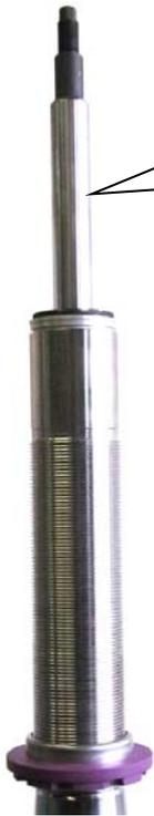
Alle Teile von dem bereits verbauten Federbein demontieren. Anschließend sollte das Federbein gründlich gereinigt werden.
