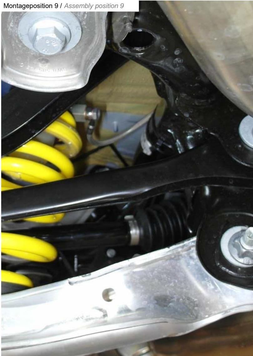
Hydraulikleitung am HLS Ringzylinder mit der mitgelieferten Hohlsschraube und 2 Dichtscheiben montieren. HLS Ringzylinder so positionieren, dass dieser mit der Hydraulikverschraubung zur Fahrzeuginnenseite zeigt. Anzugsdrehmoment 15Nm.
