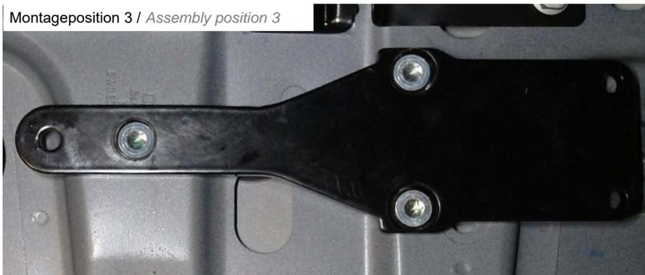
Halterung mit den mitgelieferten Schrauben M8x20 montieren. Das Anzugsdrehmoment der Schrauben beträgt 20Nm.
