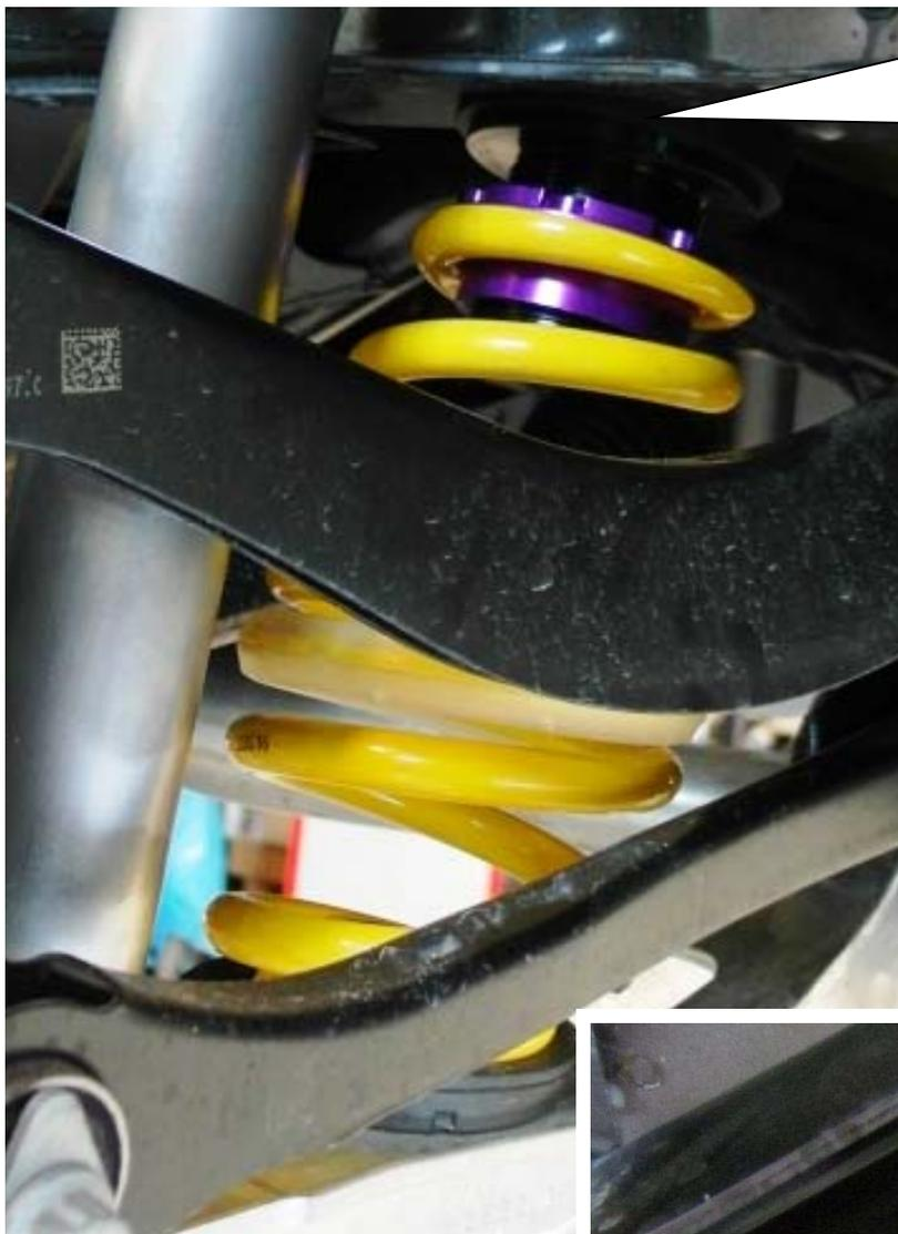
Bereits montierte HA Verstellung gegen den mitgelieferten HLS Zylinder austauschen.
