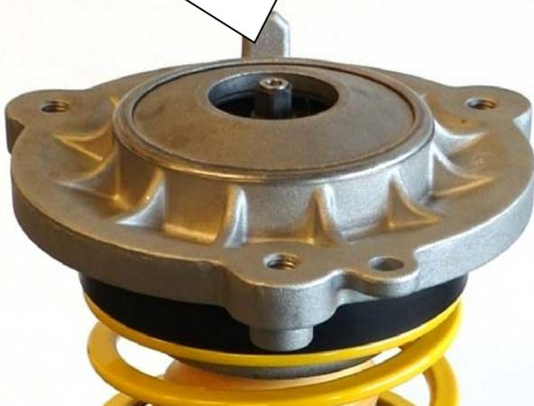
Original Abdeckung am Stützlager wieder montieren.
