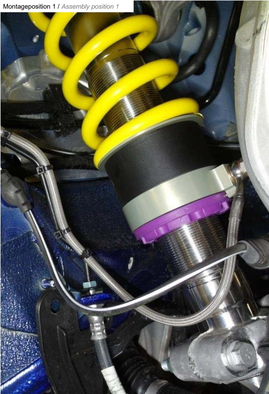
Hydraulikleitung am HLS Ringzylinder mit der mitgelieferten Hohl-schraube und 2 Dichtscheiben montieren. Anzugsdrehmoment beträgt 15Nm.
