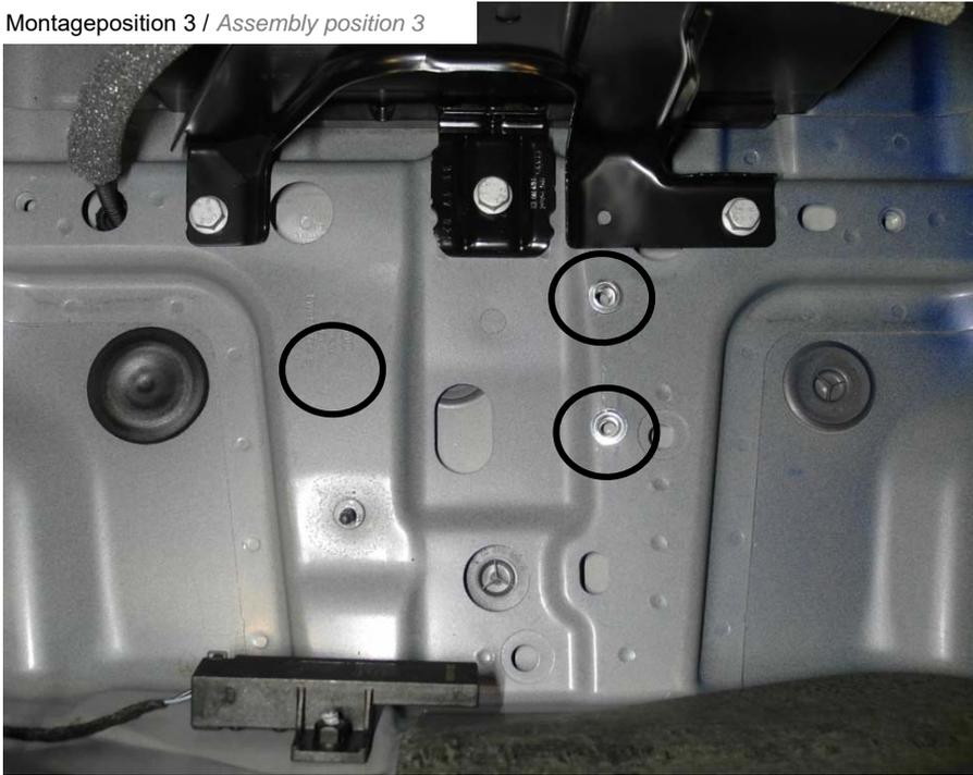
Markierungen durchbohren und die mitgelieferten Einnietmuttern montieren. Erforderliche Bohrung  $\varnothing$  11 mm.
