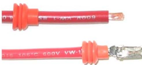
Aderabdichtung auf die Plusleitung aufstecken, Leitung 6 mm abisolieren und Kontakt mit einem geeignetem Werkzeug montieren.
