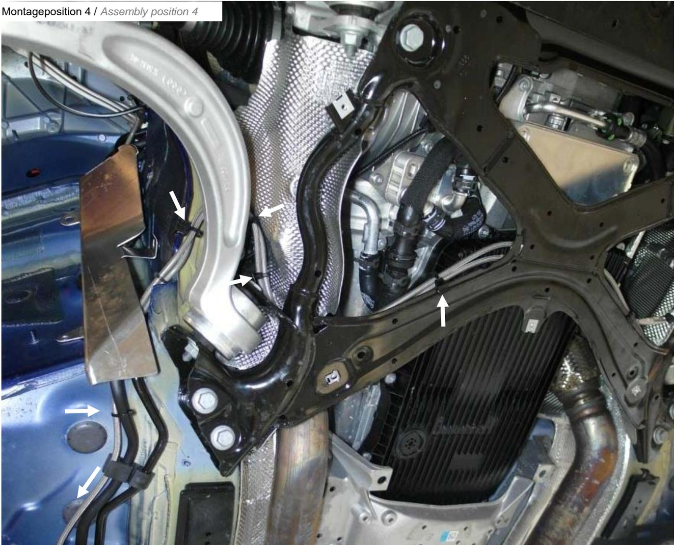
Hydraulikleitung mit Kabelbinder an der Kraftstoffleitung befestigen. Die Leitungen dürfen auf keinen fall aneinander scheuern.
