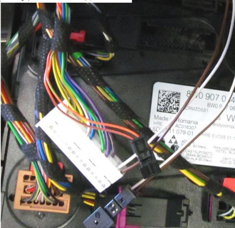
Anschließend die vom Y-Adapter abgehenden Kabel in den Originalstecker einstecken.
