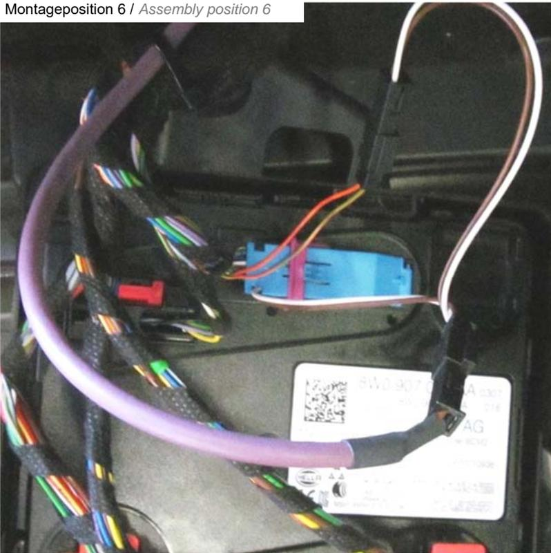
Y-Adapter mit der Original Kabelbaum verbinden. Steckergehäuse wieder anbringen und Stecker in das Steuergerät einstecken.
