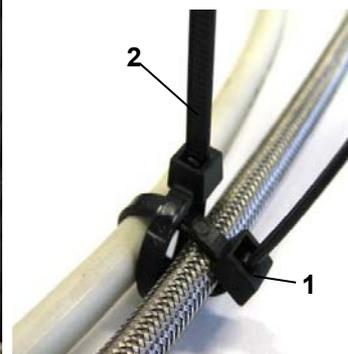
Hydraulikleitung durch die Kabeldurchführung in den Fahrzeuginnenraum verlegen. Leitung mit Kabelbindern an der Achse befestigen.
