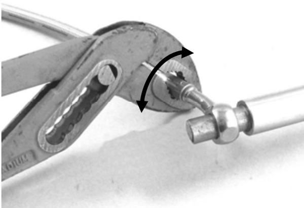
Der Anschluss der Hydraulikleitung kann mit einer Zange und einem Rundmaterial gedreht werden. Auf keinen Fall darf ein vierkant oder ähnliches verwendet werden.
