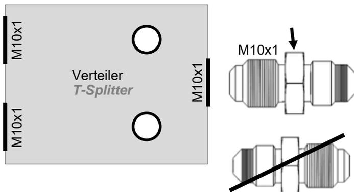
Hydraulikleitungen mit dem Verteiler verbinden. Anschließend Hydraulikleitung mit den mitgelieferten Kabelbinder an den Streben befestigen. Kabelbinder erst nach vollständiger Leitungsverlegung festziehen.
