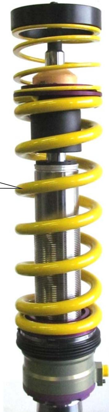
Originale Stützlagereinheit auf den Federteller aufsetzen und mit der mitgelieferten Mutter verschrauben. Das Anzugsdrehmoment der Kolbenstangenbefestigung beträgt 35 Nm. Die Montagehinweise zum Einbau des Federbeines in das Fahrzeug, sowie die Anzugsdrehmomente der Federbeinbefestigung, entnehmen Sie bitte den Unterlagen des Fahrzeugherstellers.
