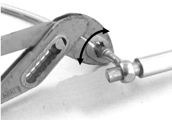
Der Anschluss der Hydraulikleitung kann mit einer Zange und einem Rundmaterial gedreht werden. Auf keinen Fall darf ein vierkant oder ähnliches verwendet werden. **Maximal 1/2 Umdrehung.**
