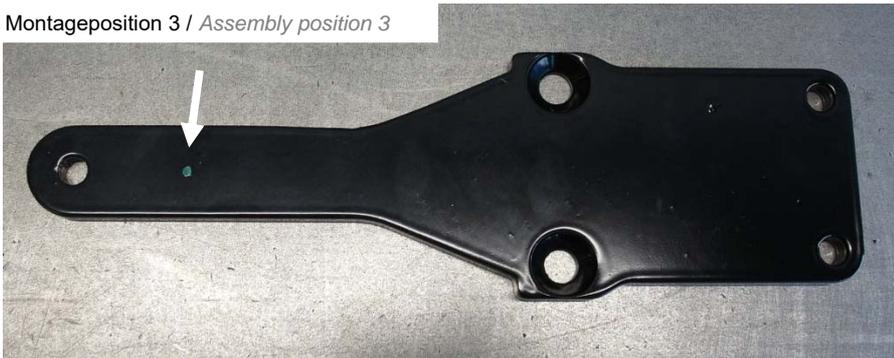
Markierung mit  $\varnothing$  10 mm durchbohren und eine Senkung mit  $90^\circ$  anbringen.
