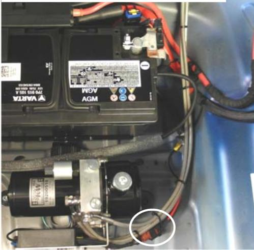
Spannungsversorgungsleitung mit dem Hydraulikaggregat verbinden und auf entsprechende Länge kürzen.
