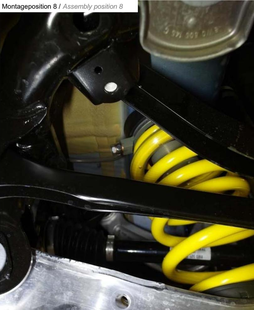
Hydraulikleitung am HLS Ringzylinder mit der mitgelieferten Hohlschraube und 2 Dichtscheiben montieren. Anzugsdrehmoment 15Nm.
