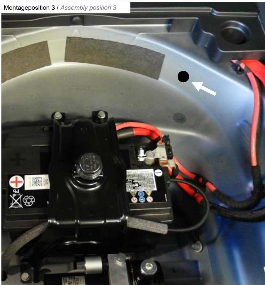
Für die Leitungsverlegung muss ein Loch mit  $\varnothing$  30 mm in die Ersatzradmulde gebohrt werden.
