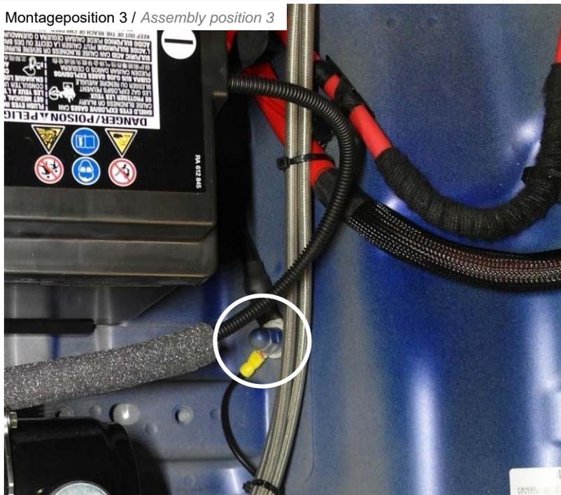
Plusleitung an der Batterie anklemmen und Masseleitung an der Fahrzeugkarosserie anklemmen.
