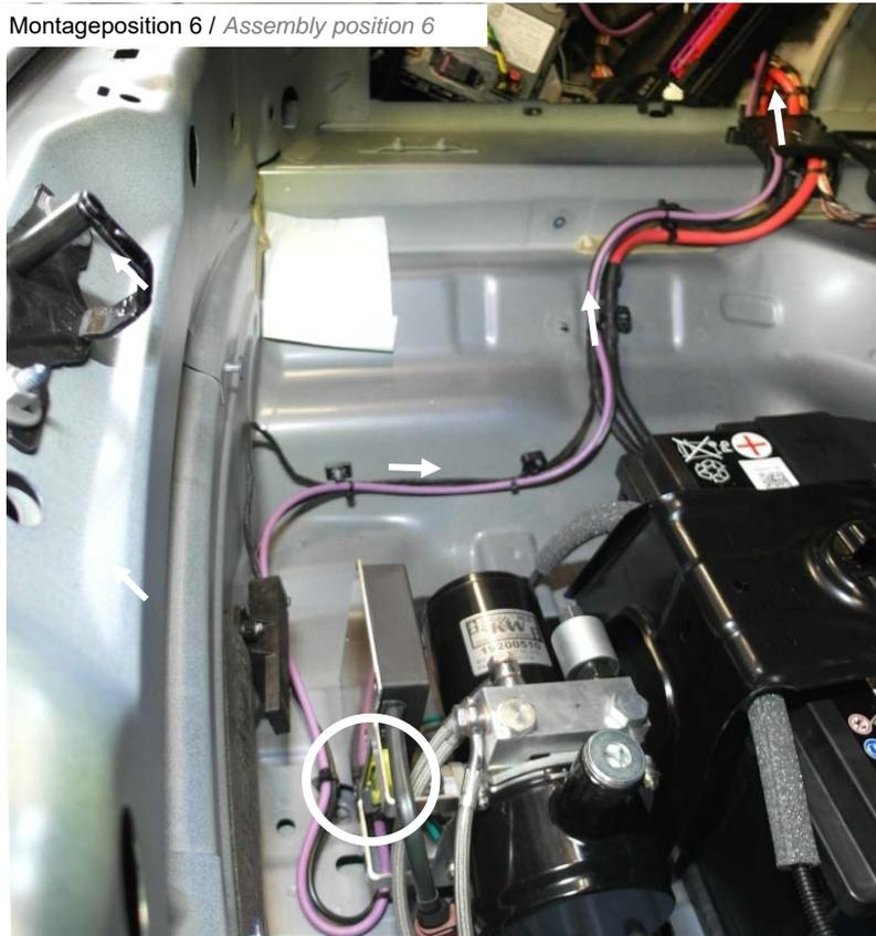
CAN Leitung in das Steuergerät der Hydraulikpumpe einstecken und entlang dem Kabelbaum zum Original Fahrzeugsteuergerät verlegen.
