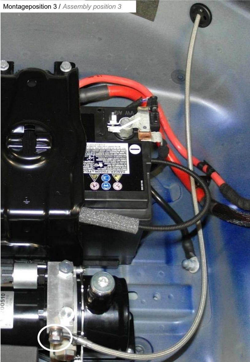
Absperrstopfen herausdrehen. Hydraulikleitung mit 2 Dichtscheiben und der kurzen Hohlschraube montieren. Anzugsdrehmoment 15Nm.
