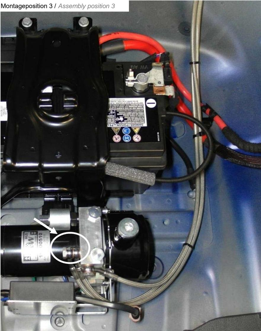
Absperrstopfen herausdrehen. Hydraulikleitung mit 3 Dichtscheiben und mit der langen Hohlschraube montieren. Anzugsdrehmoment 15Nm.
