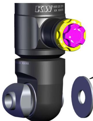
Die mitgelieferte Unterlegscheibe wird an der unteren Dämpferbefestigung montiert. Die Scheibe zeigt zur Fahrzeuginnenseite.
