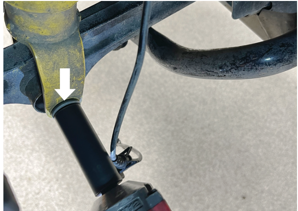
Fig. 3: Remove the lower shock bolt.
