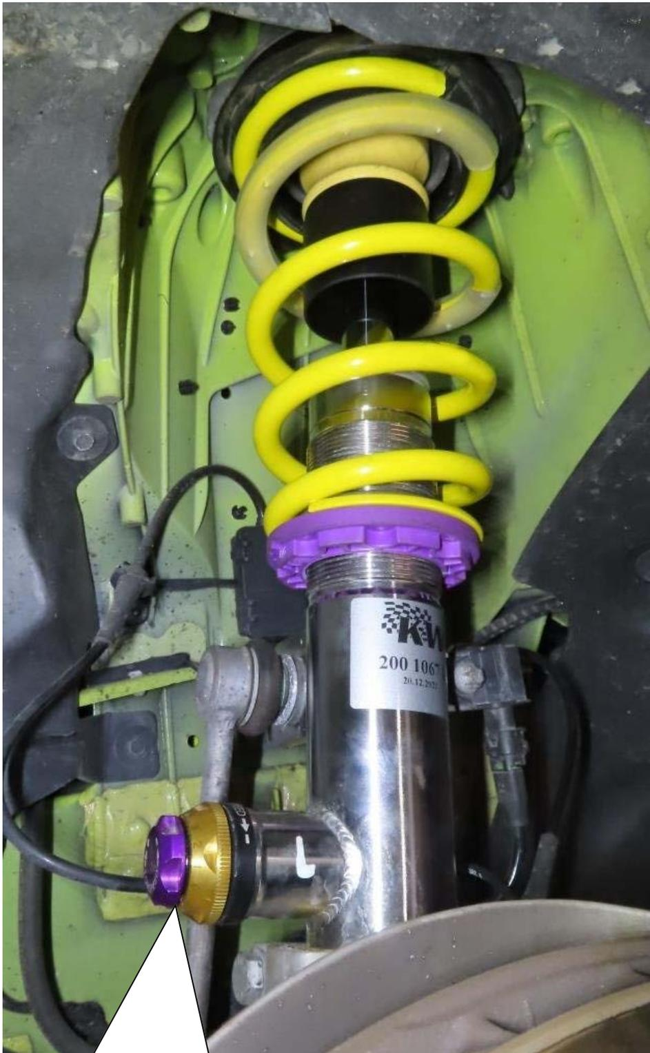
Die Druckstufeneinstellung muss zur Fahrzeugvorderseite zeigen.
