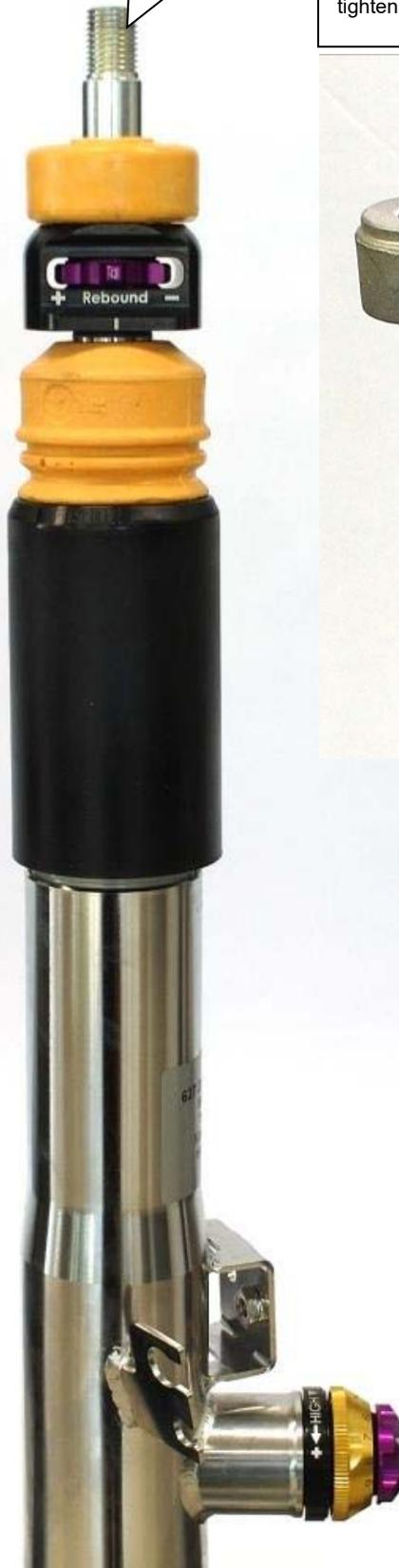
Original Stützlager auf den Dämpfer aufsetzen und mit der originalen Mutter verschrauben. Das Anzugsdrehmoment der Kolbenstangenbefestigung beträgt 25 Nm. Zusätzlich muss die Original Dichtung und die Abdeckung wieder montiert werden.
