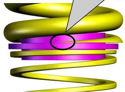
Die Druckstufeneinstellung muss zur Fahrzeugheckseite zeigen.
