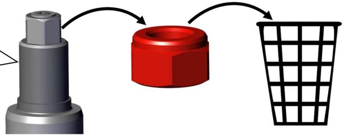
Original Faltenbalg an der gestrichelten Linie abtrennen und den oberen Teil auf die Feder aufsetzen. Der untere Teil des Faltenbalgs wird nicht mehr benötigt.
