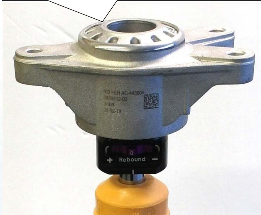
Nach der Montage muss durch Fahrversuche bzw. andere geeignete Maßnahmen die Radfreigängigkeit überprüft werden. Ist sie z. B. durch Bauteiltoleranzen des Fahrzeugs nicht gegeben, müssen Maßnahmen zur Herstellung der Freigängigkeit durchgeführt werden. Das Mindestabstandsmaß darf an der engsten Stelle **5 mm** nicht unterschreiten.
