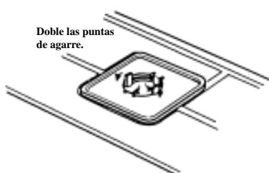
**DOBLE HACIA FUERA LAS DOS PUNTAS DE LA MITAD INFERIOR DEL REDUCTOR** sobre el borde exterior de la mitad superior del reductor, empleando para tal una herramienta sin filo. Asegúrese de que las puntas de agarre queden bien apretadas de modo que el conjunto reductor se mantenga en lugar con firmeza en el cuerpo de la empaquetadura. Invierta la empaquetadura y repita la operación de doblar las puntas de agarre con la otra mitad del reductor.
