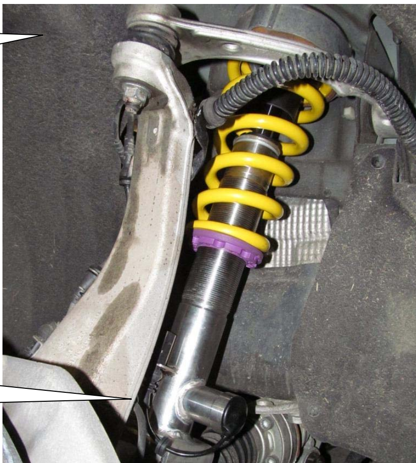
Das DDC Ventil muss zur Fahrzeugheckseite zeigen. Mount the DDC vent facing to the rear of the vehicle.
