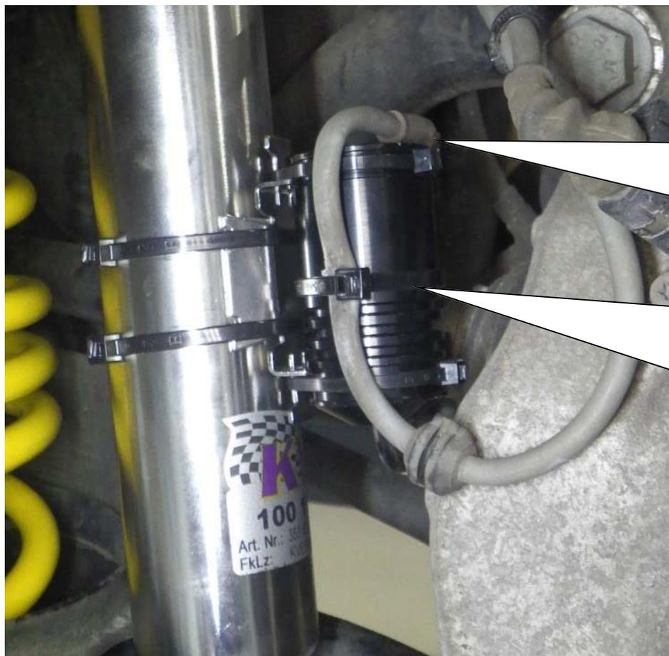
Stecker des Elektronikbauteils in die Original Buchse einstecken. Auf die korrekte Verriegelung des Steckers achten! Anschließend originale Dämpfersteuerungsleitung mit Kabelbindern befestigen.
