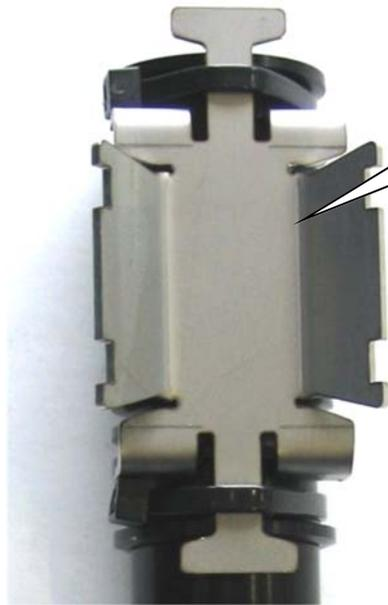
Klebeband auf den montierten Halter ankleben.
