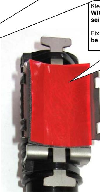
Klebeband auf den montierten Halter ankleben.
