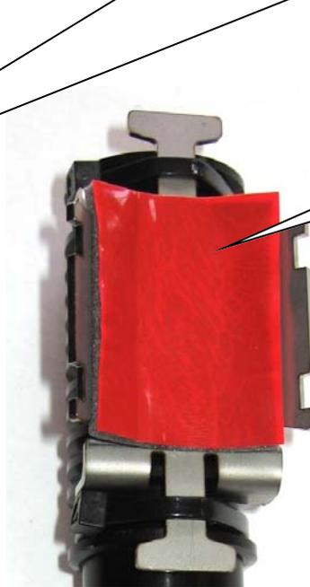
Klebeband auf den montierten Halter ankleben. **WICHTIG: Klebefläche muss Staub- und Fettfrei sein.**
