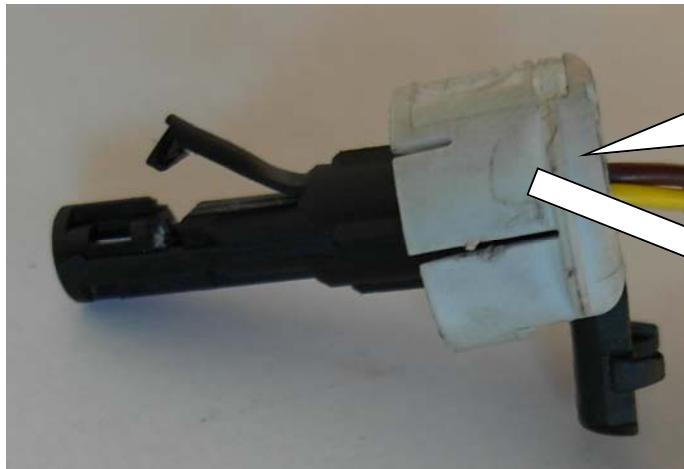
2. Steckersicherung öffnen und Originale Dämpferleitungen mit geeignetem Werkzeug aus dem Stecker auspinnen.
