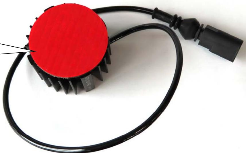
Dämpfersteuerungsleitung in den mitgelieferten Elektroniksatz einstecken. Auf die korrekte Verriegelung des Steckers achten!
