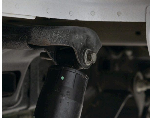
Fig. 19: Remove upper shock mount bolt.
